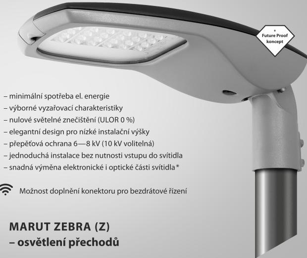
Je speciální variantou typové řady svítidel MARUT s označením "**ZEBRA**", určenou k osvětlení přechodů pro chodce. Svítidla se vyrábí s teplotou chromatičnosti odlišující se od barvy světla okolní světelné soustavy veřejného osvětlení z důvodů vzdáleného upozornění řidiče ve vnímání na přechod pro chodce.
