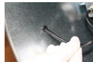
Kabel provlíknete směrem do tubusu
