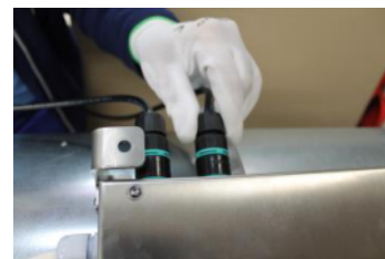
Povolením převlečného kroužku uvolněte a odpojte příslušný konektor
