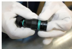
Konektor rozmontujte a kabel odpojte ze svorek
