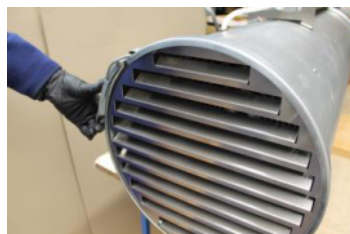
Pomocí zátky uvolněte stahovací obruč a sejměte krycí mřížku a obruč
