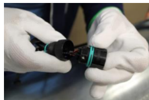
Konektor rozmontujte a kabel odpojte ze svorek
