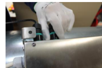
Povolením převlečného kroužku uvolněte a odpojte příslušný konektor
