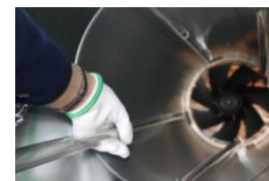
Trubici uvolněte z držáků a vysuňte z tubusu
