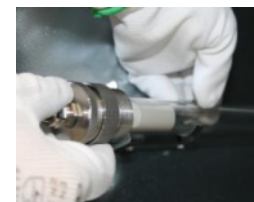
Trubici uvolněte z držáků a vysuňte z tubusu
