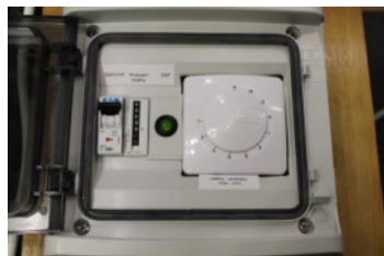
Panel ovládací GERMIN TUBE, hlavní vypínač, počítadlo provozních hodin, signalizace stavu zapnutí a regulátor otáček motoru
